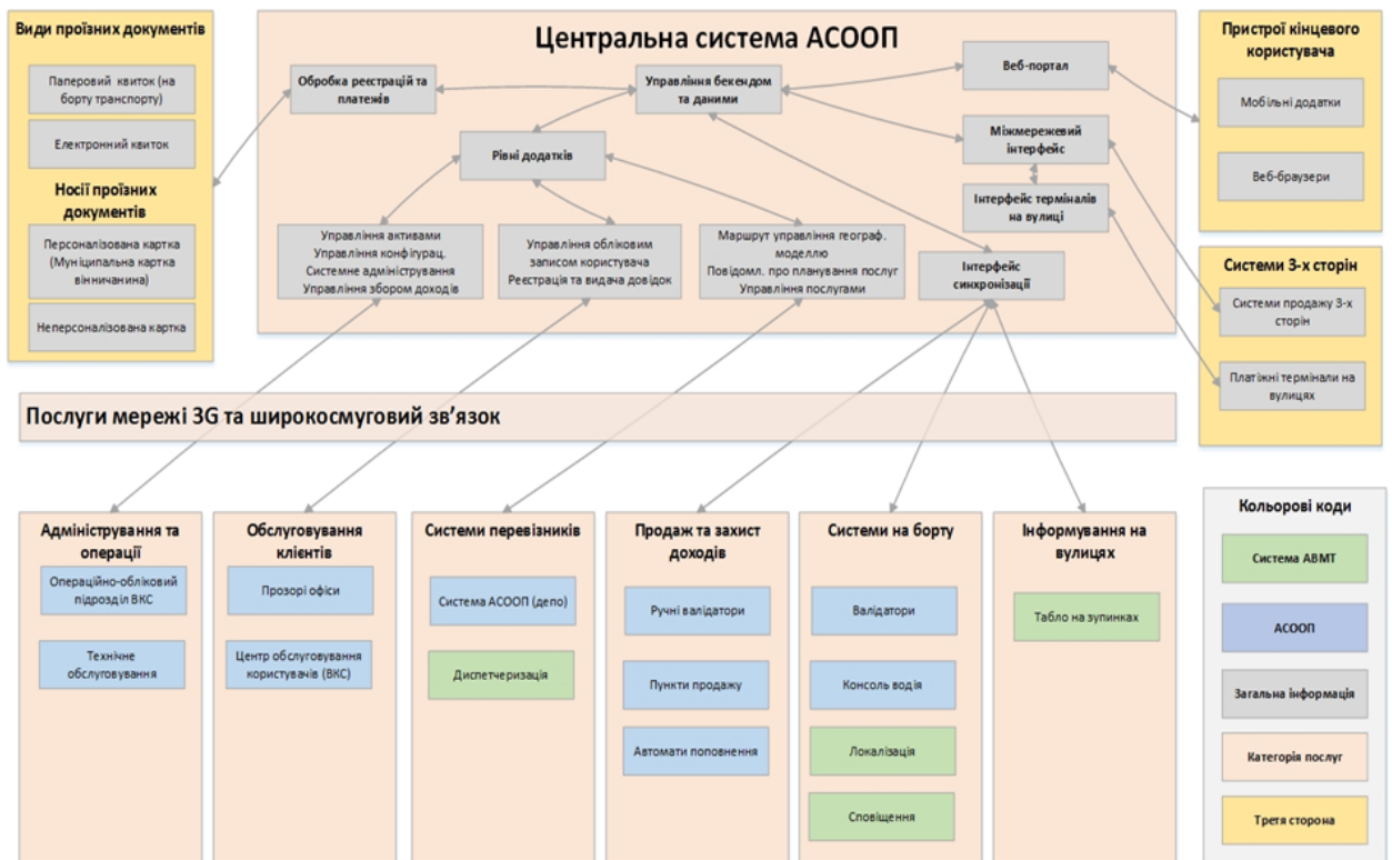
Рис.1. Схема функціонування автоматизованої системи обліку оплати проїзду та системи автоматичного визначення місцезнаходження транспортних засобів
